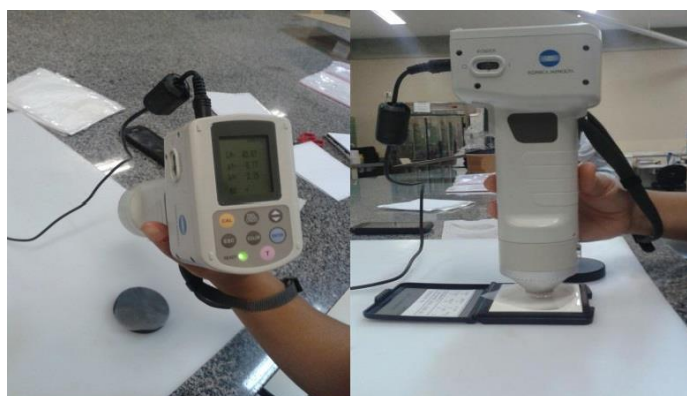
Figura 14: Análise de cor dos filmes produzidos, através do colorímetro Konica Minolta CR- 400.
