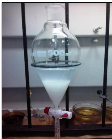
Figura 11: Neutralização do m -CPBA com solução de \text{NaHCO}_3 saturada.
