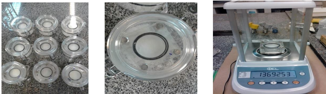
Figura 18: Cápsulas de acrílico contendo as células de permeação para análise de permeação em vapor de água.
