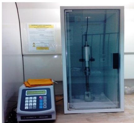
Figura 8: Sonda ultrassônica utilizada na epoxidação dos ésteres.
